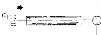
**Viento actuando por el extremo de un cilindro**
